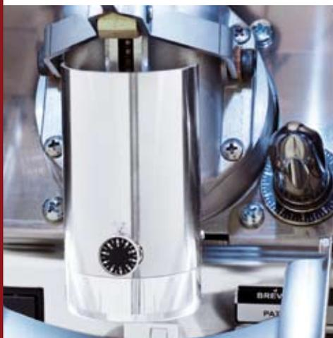
Per garantire una giusta macinatura del caffè, il sistema è regolabile micrometricamente attraverso lo scorrimento assiale del rotore. Un pomello permette di selezionare un'ampia graduazione della polvere di caffè.
