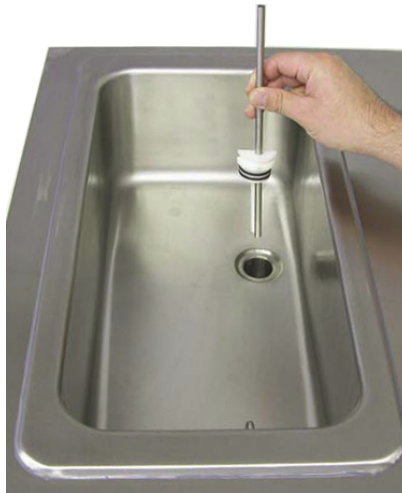
Mixbehållare med mix- och luftinblandningsrör
